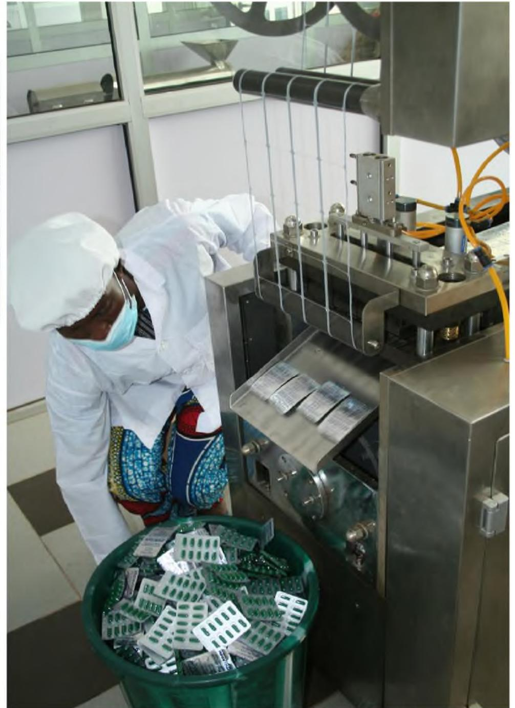
●9- Unité de production de comprimé : 100000 comprimés à l'heure / Tablet production unit: 100,000 tablets per hour
