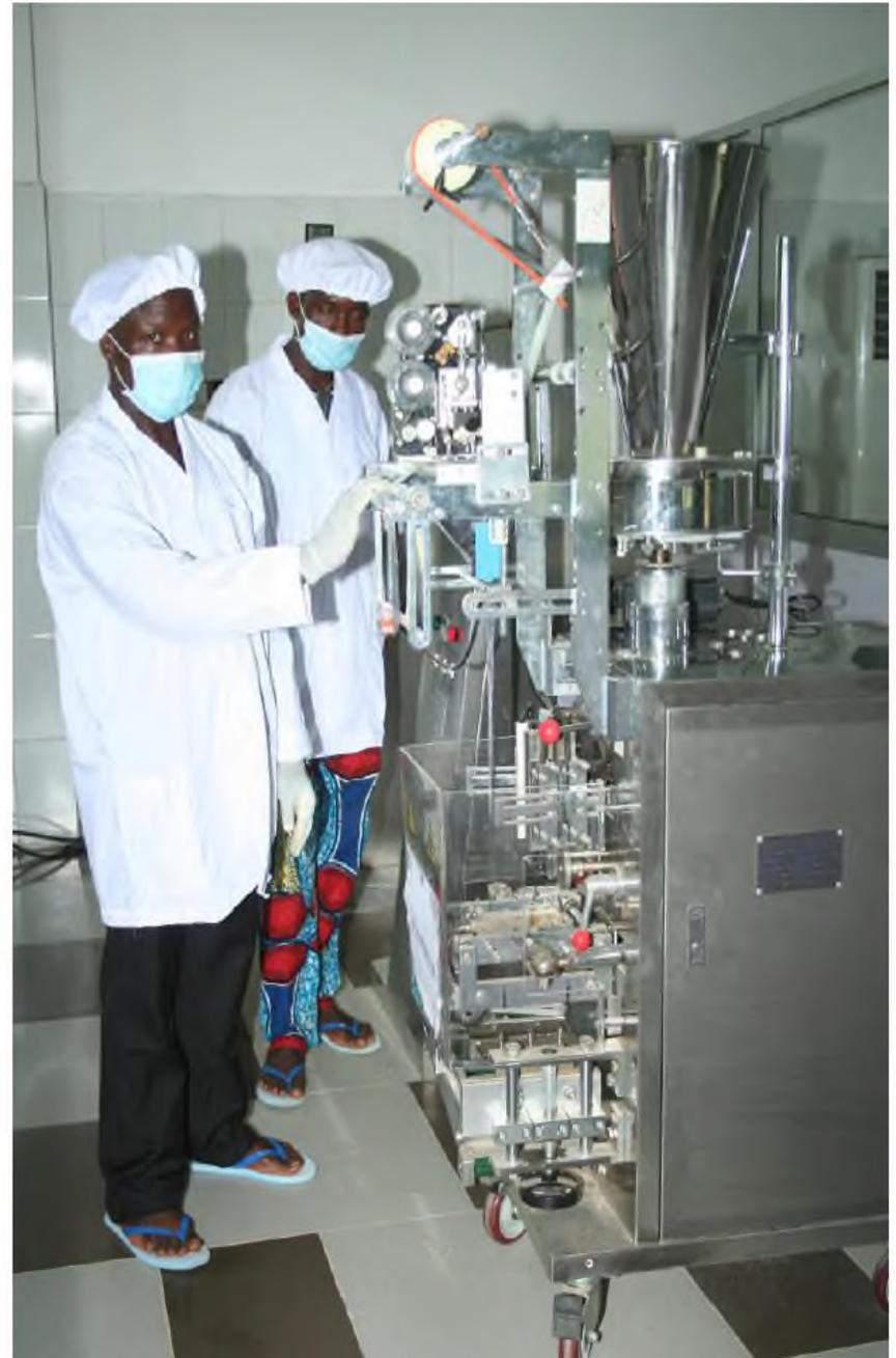
●11 - Unité de conditionnement de sirop en vial (ampoule grandeur nature) / Syrup conditioning unit in vial (size bulb)
